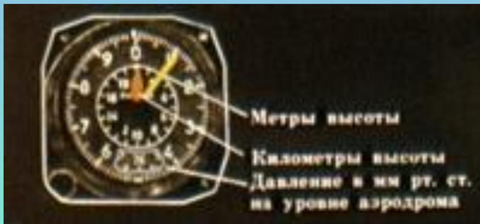
Идея опыта Паскаля легла в основу конструкции альтиметра. Он определяет высоту подъема
