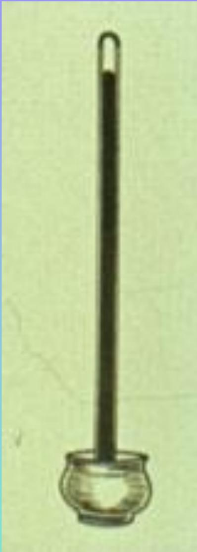
Торричелли - трубка со ртутью была первым барометром.
