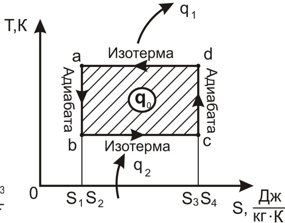
$a - b$  - адиабатное расширение сжатого газа. Температура резко понижается;
