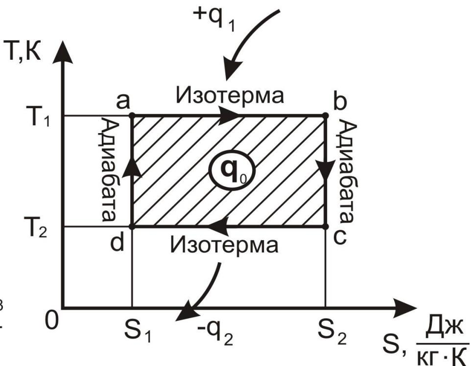
На участке расширения  $a-b$  к рабочему телу подводиться от нагревателя количество теплоты  $q_1$  при температуре . Далее на участке происходит садиабатное расширение от температуры до  $T_1$   $T_2$
