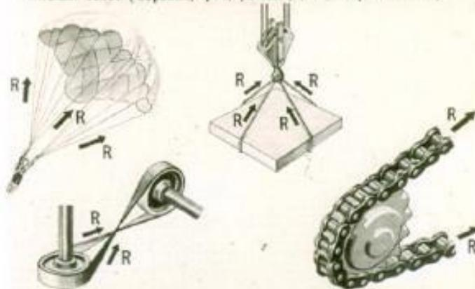
Реакция связи ( $R$ ) направлена по гибкой связи. Гибкие связи работают только на растяжение.
