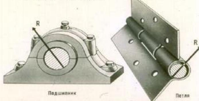
Реакция связи ( $R$ ) цилиндрического шарнира направлена перпендикулярно к оси шарнира.
