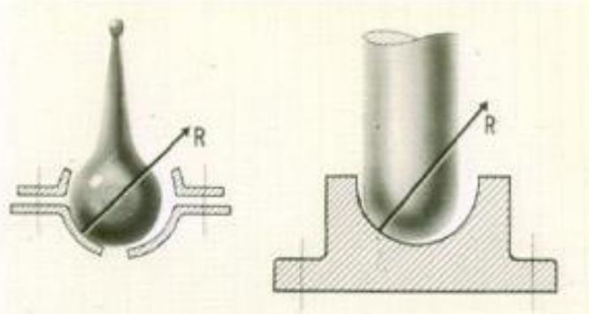
Реакция связи ( $R$ ) сферического шарнира направлена в пространстве произвольно.
