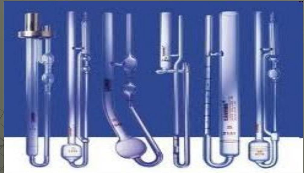
Плотность исследуемой жидкости  $\rho_x$  можно измерить с помощью ареометра. В качестве эталонной жидкости обычно берется вода. Ее плотность  $\rho_0$  и коэффициент внутреннего трения находят по таблицам. Так как коэффициент внутреннего трения сильно зависит от температуры, измерения производят в условиях термостатирования. Для этого помещают вискозиметр в банку с водой, которая является термостатом.
