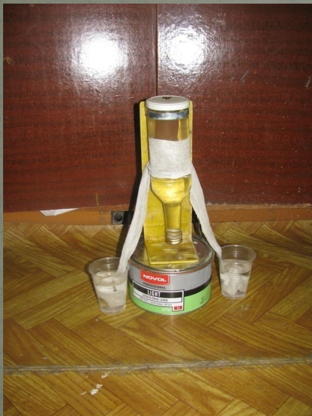
Внешний вид кристаллизатора для выращивания кристаллов АDR статическим методом
