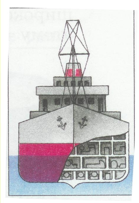
Почему же плавает корабль, корпус которого сделан из железа? Потому что подводная часть корабля заполнена воздухом, который вытесняет очень большой объём воды и очень мало весит. Но если в его корпусе появится пробоина, то трюм заполнится водой, и корабль утонет.
