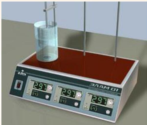
Лабораторная электролизная установка для анализа металлов «ЭЛАМ».
