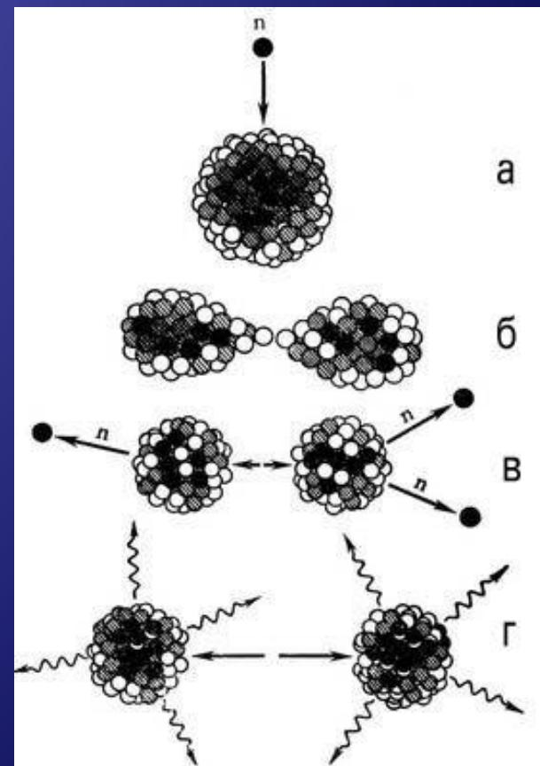
Любой из нейтронов, вылетающих из ядра в процессе деления, может, в свою очередь, вызвать деление соседнего ядра, которое тоже испускает нейтроны способные вызвать дальнейшее деление. В результате число делящихся ядер очень быстро увеличивается. Возникает цепная реакция. **Ядерной цепной реакцией** называется реакция, в которой частицы, вызывающие ее (нейтроны), образуются как продукт этой реакции.
