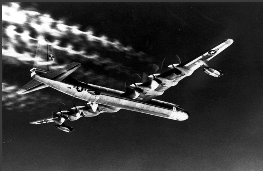
Convair NB-36H — самолёт-лаборатория для испытания атомных реакторов в полёте, США
