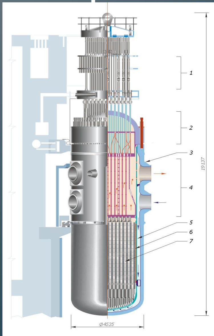
Реактор ВВЭР 1000. 1 — привод СУЗ; 2 — крышка реактора; 3 — корпус реактора; 4 — блок защитных труб (БЗТ); 5 — шахта; 6 — выгородка активной зоны; 7 — топливные сборки (ТВС) и регулирующие стержни;
