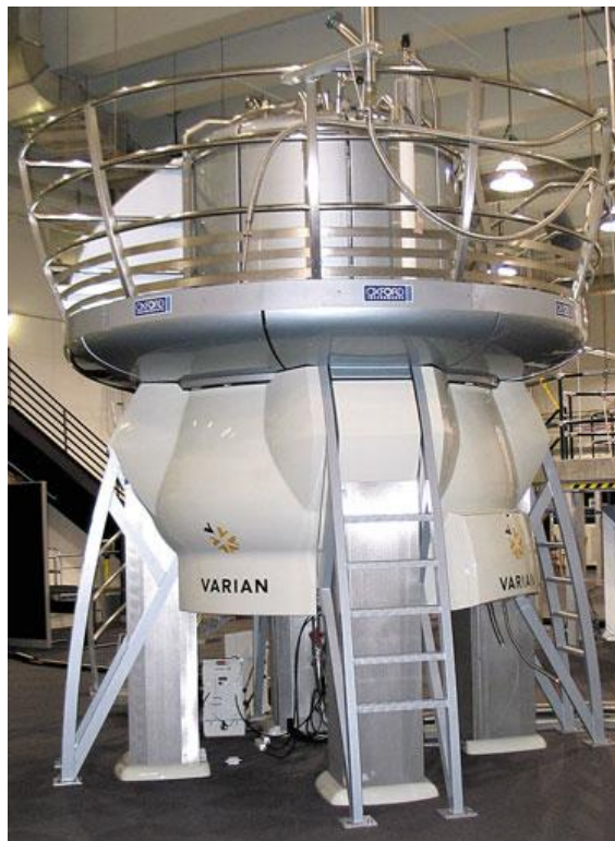
Магнит спектрометра ЯМР на 900 МГц
