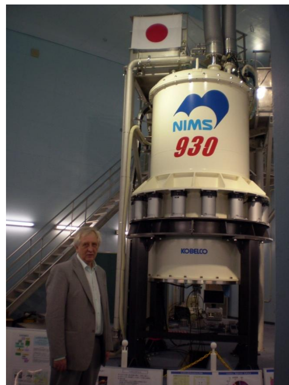
Магнит спектрометра ЯМР на 930 МГц
