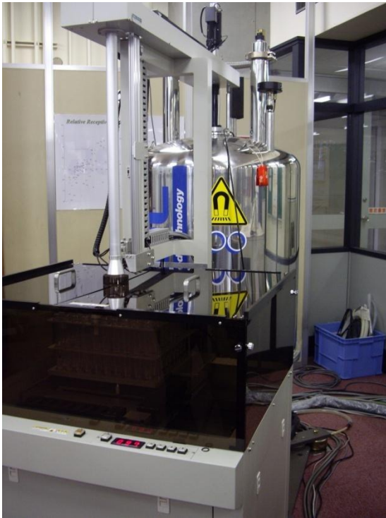
Робот для автоматической смены ампул (автосамплер) на 100 образцов.
