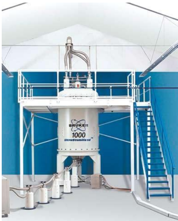
Магнит спектрометра ЯМР на 1000 МГц
