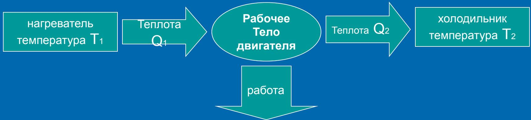
Рабочим телом двигателя является газ, т.к. газ лучше всего сжимается и расширяется при изменении температуры. Работа, совершаемая двигателем (газом)
