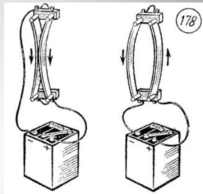
Явление взаимодействия электрических токов Ампер назвал *электродинамическим взаимодействием*.
