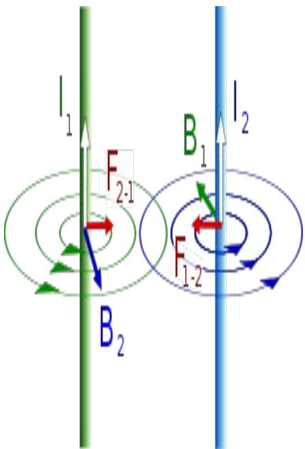
Два бесконечных параллельных проводника в вакууме
