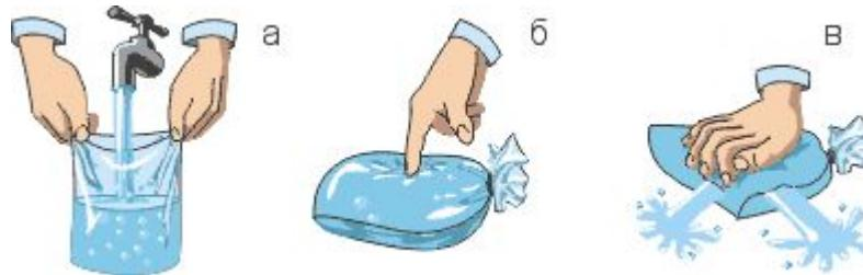
Давление, производимое на жидкость или газ, распространяется без изменения во все части жидкости или газа.
