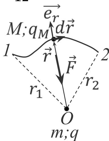
Элементарная работа  $\delta A = \vec{F} d\vec{r} = \left(\frac{\alpha}{r^2}\right) \vec{e}_r \cdot d\vec{r}$ , где  $\vec{e}_r d\vec{r} = dr$ , поэтому  $\delta A = \alpha \frac{dr}{r^2} = -d\left(\frac{\alpha}{r}\right)$ .
