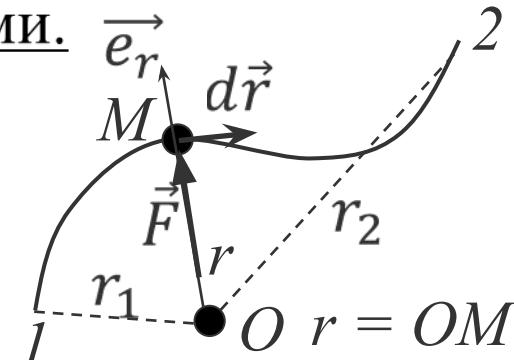
Элементарная работа силы (7) на перемещении  $d\vec{r}$  есть  $\delta A = \vec{F} d\vec{r} = f(r) \vec{e}_r d\vec{r} = f(r) dr$ , так как  $\vec{e}_r d\vec{r} = dr$ . Тогда работа этой силы на произвольном пути от т. 1 до т. 2:
