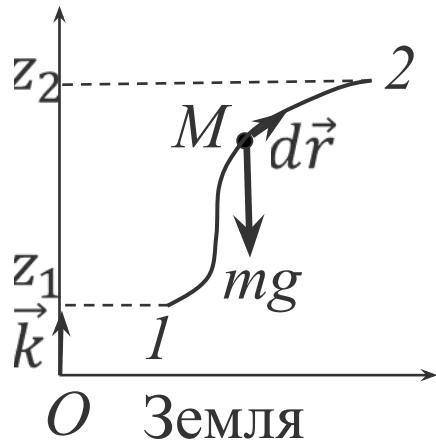
Элементарная работа  $\delta A = \vec{F} d\vec{r} = -mg\vec{k} \cdot d\vec{r}$ , где  $\vec{k} d\vec{r} = (dr)_k = dz$ , поэтому  $\delta A = -mgdz = -d(mgz)$ . Таким образом, полная работа на пути 1-2:  $A_{12} = - \int_{r_1}^{r_2} d(mgz) = mg(z_1 - z_2)$ , где справа стоит убыль потенциал. энергии; а значит  $U(r) = mgz$  – потенциальная энергия частицы, поднятой на высоту  $h = z$  над Землей.
