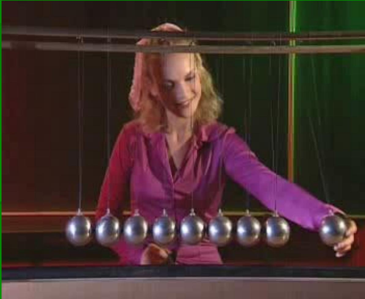
В данном опыте импульс передается от одних тел, входящих в замкнутую систему, к другим телам
