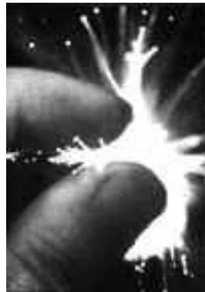
Рис. 1.18. За счет многократного полного отражения свет может быть направлен по любому прямому или изогнутому пути
