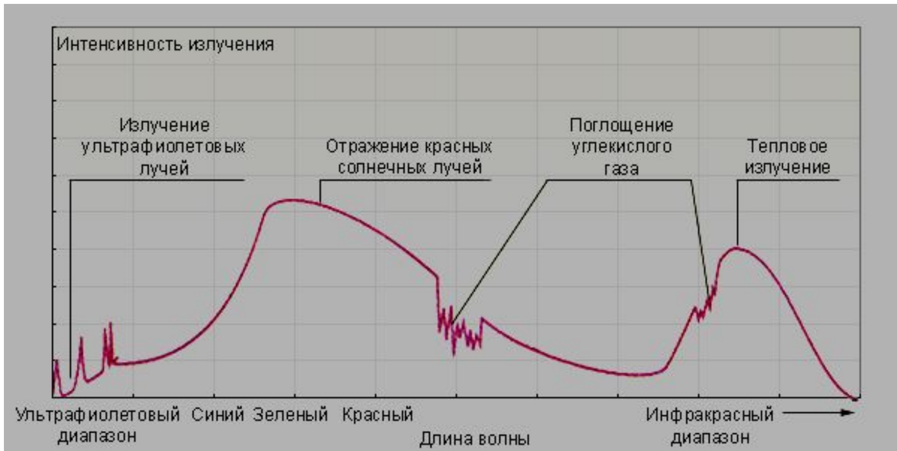
Рис. 1.2. Прохождение электромагнитного излучения сквозь атмосферу
