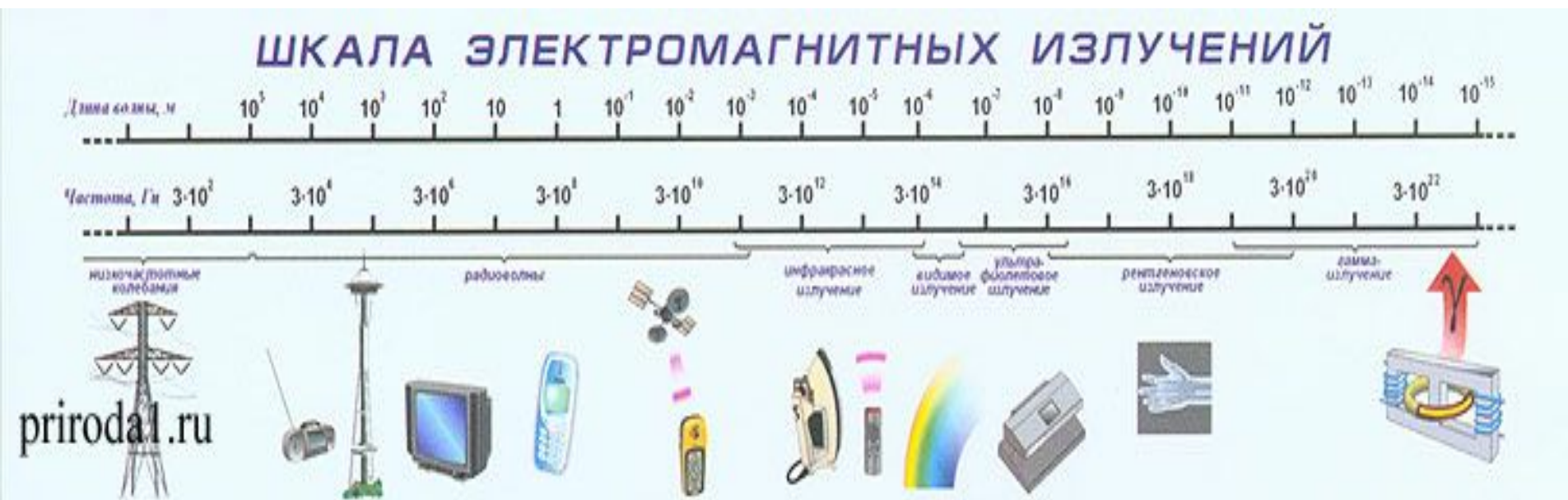
Рис. 1.1,в. Шкала электромагнитных излучений. По горизонтальной оси отложены: внизу – частота колебаний, Гц; вверху – длина волны, м
