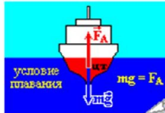
Сила Архимеда определяется **плотностью воды** и **объёмом подводной части корабля**
