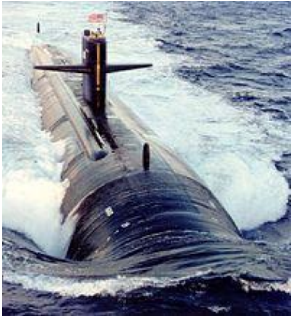
Ламинарное (на переднем плане) и турбулентное течение вокруг субмарины «Лос-Анджелес»
