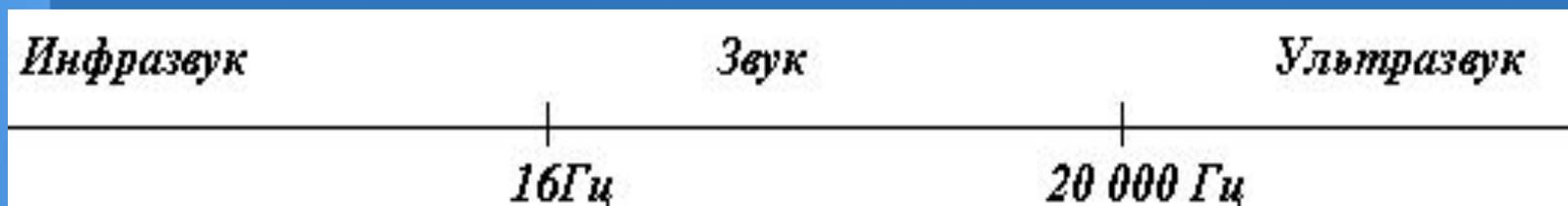
Волны с частотой менее 20 Гц называются **инфразвуком**, а с частотой более 20 кГц – **ультразвуком**.
