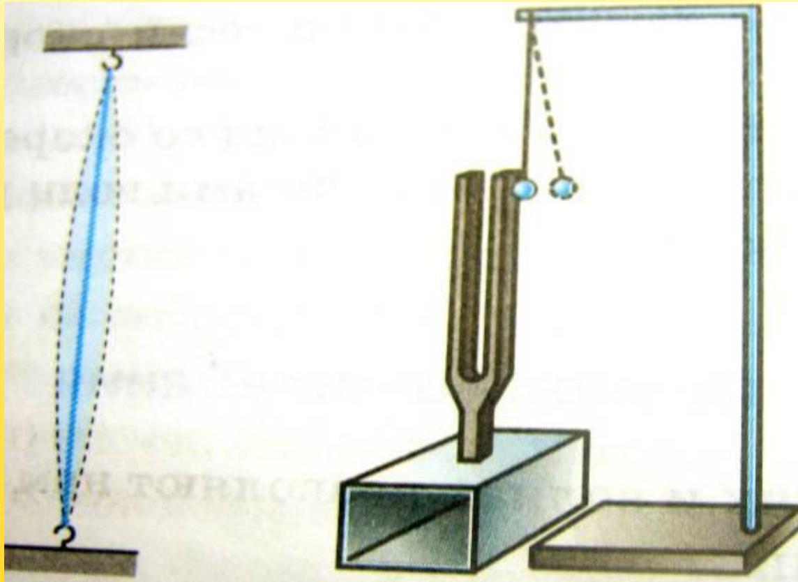
Ножки камертона устанавливают на полый ящик определенной длины открытый с одной стороны. Ящик-резонатор. Он усиливает звук, возникающий при колебаниях ножек камертона.
