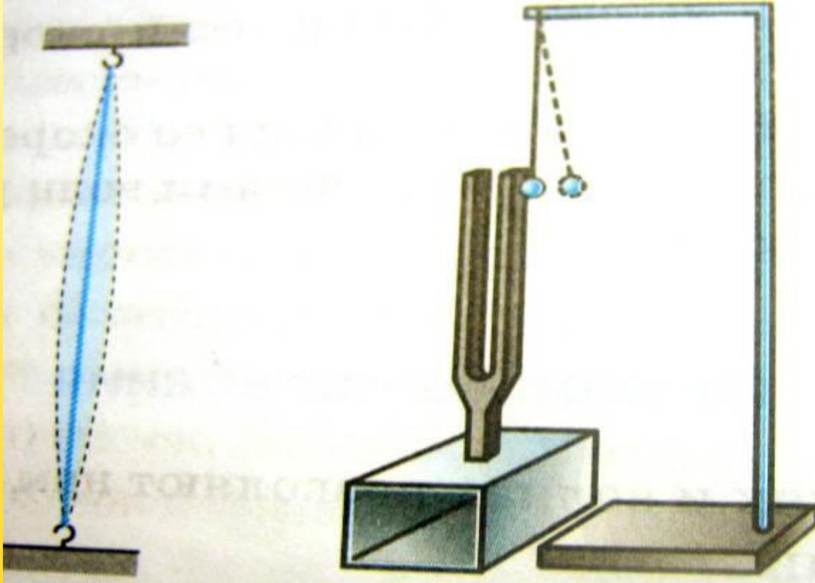
Ножки камертона устанавливаются на полый ящик определенной длины открытый с одной стороны. Ящик-резонатор. Он усиливает звук, возникающий при колебаниях ножек камертона.
