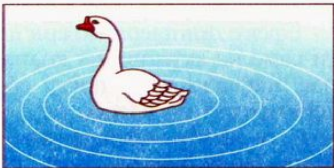
Мал. 2.34. З наближенням до спостерігача довжина хвилі зменшується
