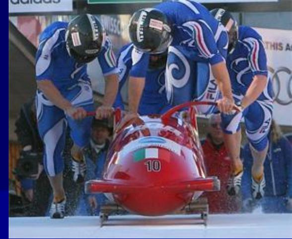
Сани здесь, именуемые бобом, имеют цельнометаллический кузов обтекаемой формы, который закреплен на двух парах полозьев-коньков: передней подвижной с рулем и задней неподвижной с тормозом. На соревнованиях используют двухместные бобы (двойка)- длина не более 2,7 м, масса не свыше 165 кг, вес экипажа не более 200 кг и четырехместные (четверка)- соответственно 3,8 м, 230 кг, 400 кг.
