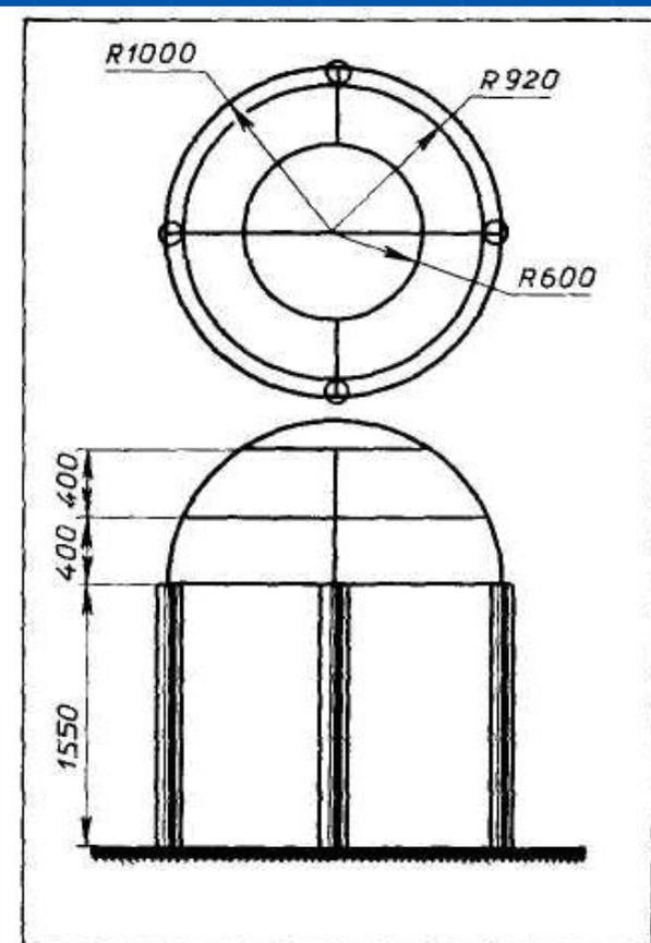
Рис 53 Нефоскопическая сетка (вид сверху и сбоку)
