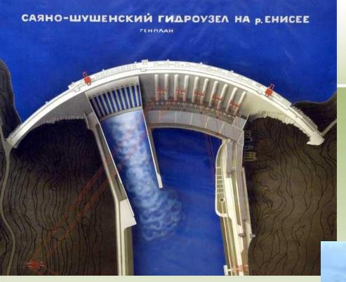
Состав сооружений ГЭС: бетонная арочно-гравитационная плотина высотой 245 м, длиной 1 066 м, шириной в основании — 110 м, шириной по гребню 25 м.
