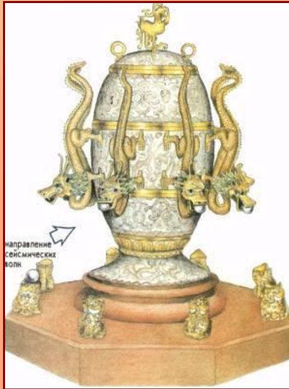
Первый прибор, способный улавливать колебания земной поверхности (132 г., Китай)
