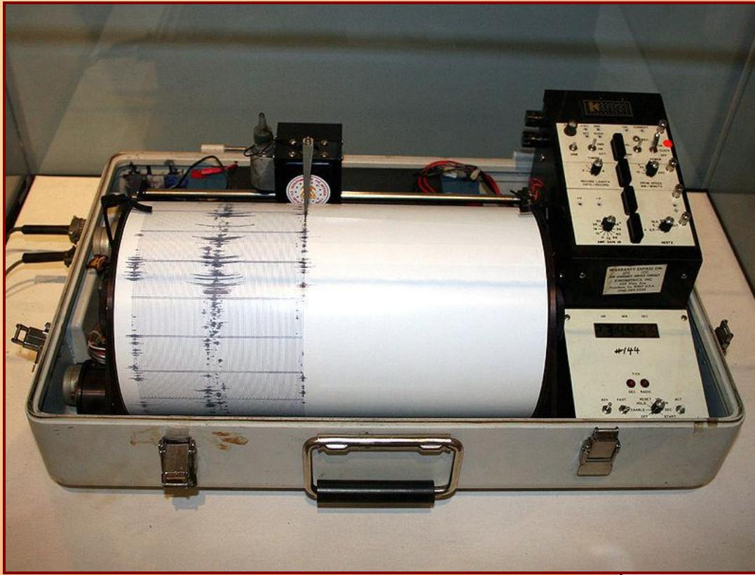
**Сейсмограф — прибор для записи колебаний земной поверхности во время землетрясений или при взрывах**
