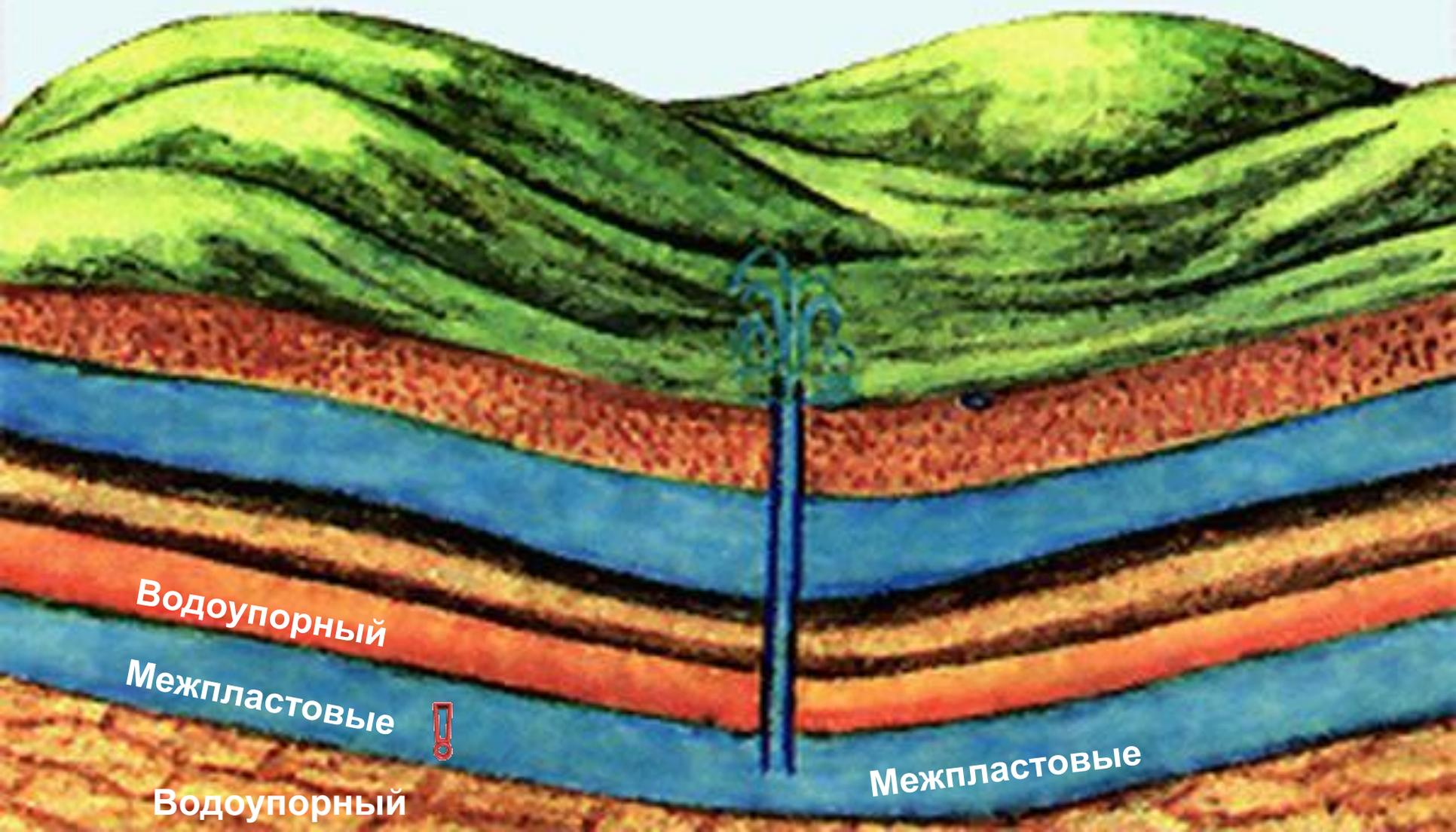
Если слои залегают чашеобразно, вода под напором поднимается по скважине и бьет фонтаном. Такие воды называются **артезианскими**.
