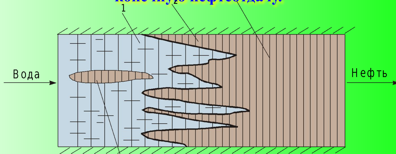
Рис. Схема движения водонефтяного контакта в пласте при \mu = 20 - 30 \cdot 10 \text{ Па с} 1-область, занятая водой и остаточной нефтью; 2-водонефтяной контакт; 3-область, занятая нефтью; 4-скопление нефти, оставшейся позади в/н контакта
