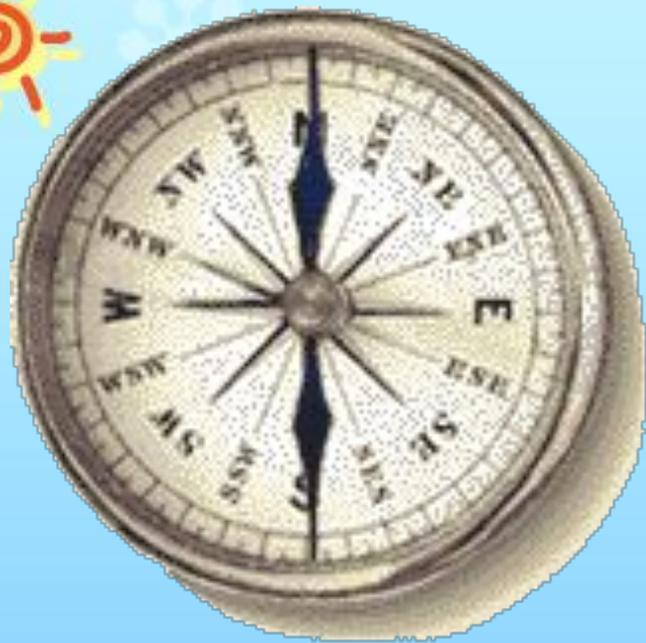
**КОМПАС** - прибор, указывающий направление географического или магнитного меридиана; служит для ориентирования относительно сторон горизонта.
