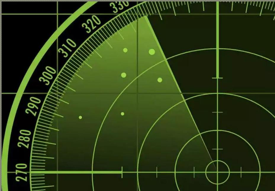
Радары могут на расстоянии в сотни километров отслеживать движение кораблей и самолётов даже в темноте или когда небо покрыто тучами. Большая антенна посылает короткие сигналы радиоволн. Если они попадают в какой-либо объект, то отражаются. Радар получает эти отражённые сигналы и перемещает их на экран. По направлению импульса и углу горизонта прибор может определить положение корабля (или самолёта)
