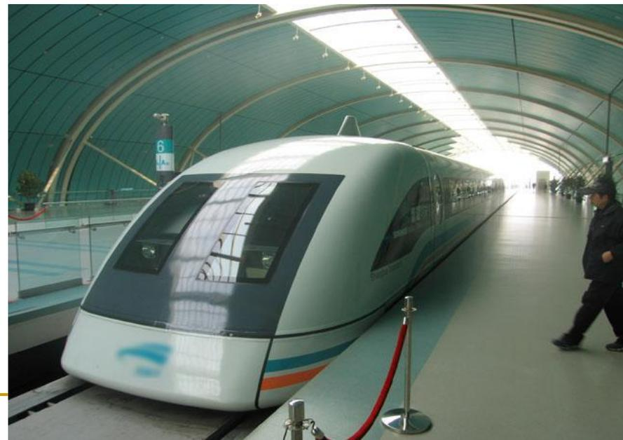
■ Это поезд, удерживаемый над полотном дороги, движимый и управляемый силой электромагнитного поля. Такой состав, в отличие от традиционных поездов, в процессе движения не касается поверхности рельса. Так как между поездом и поверхностью полотна существует зазор, трение между ними исключается, и единственной тормозящей силой является аэродинамическое сопротивление.
