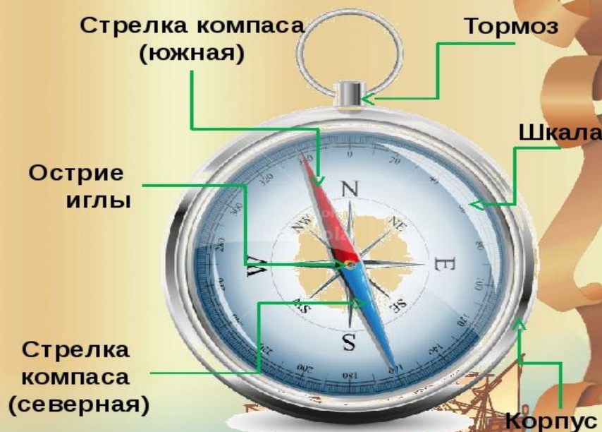
Схема устройства магнитного компаса
