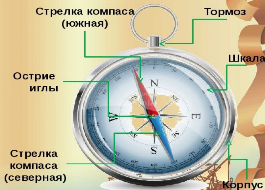
Схема устройства магнитного компаса
