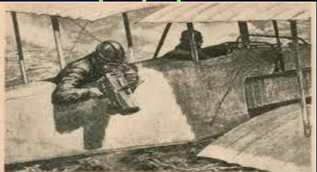
Авиационная фотоаппаратура. Французский авиатор Жюль Нанкер, облетев 14 германских городов, на своем аэроплане, оснащенном аппаратурой Спеллера, снимал промышленные устройства фотографической аппаратурой для съемки с высоты, включая железнодорожные и промышленные объекты изобретенного авиатора. Длина кадра—60 сантиметров, высота—25 сантиметров. Такие же были найдены в других местах и считались ценными. По образцу этого авиатора французская авиация уже не в состоянии уже снимать авиацию. На рисунке изображен типичный авиационный аппарат, применяемый на время войны для аэрофотографии.
