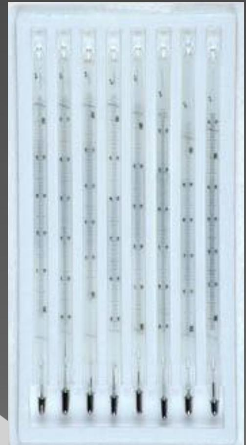
Сплав ртути с таллием используется для низкотемпературных термометров.
