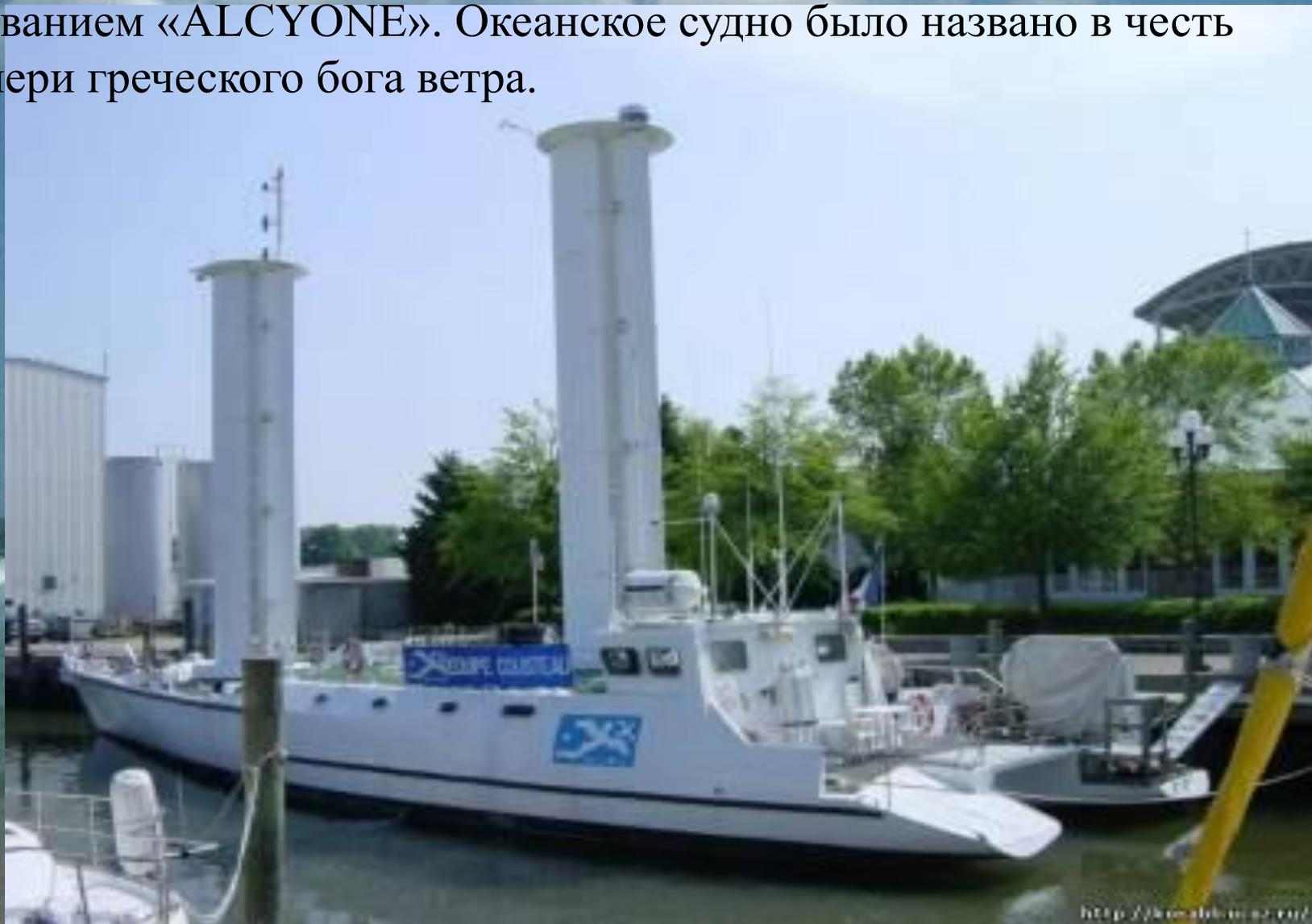
Корпус гидрографического судна был выполнен из алюминия, что позволило снизить качку. С капитанского мостика можно управлять работой всего оборудования и самое главное изменять угол наклона установки. Бортовой компьютер позволяет анализировать ее работу.
