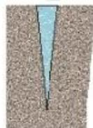
Вода замерзает в трещине и расширяется
