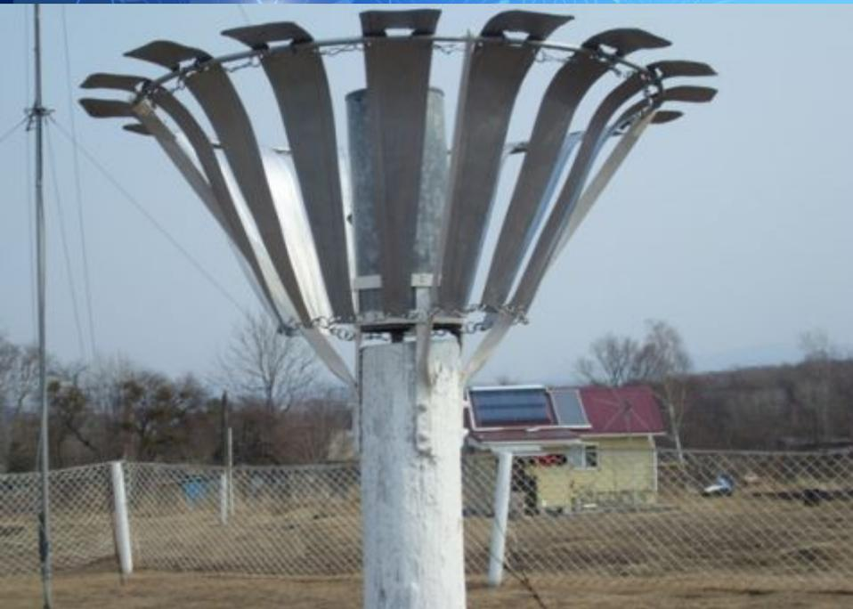
Ветроизмерительные приборы – флюгеры Вильда. Они измеряют скорость, силу и направление ветра.
