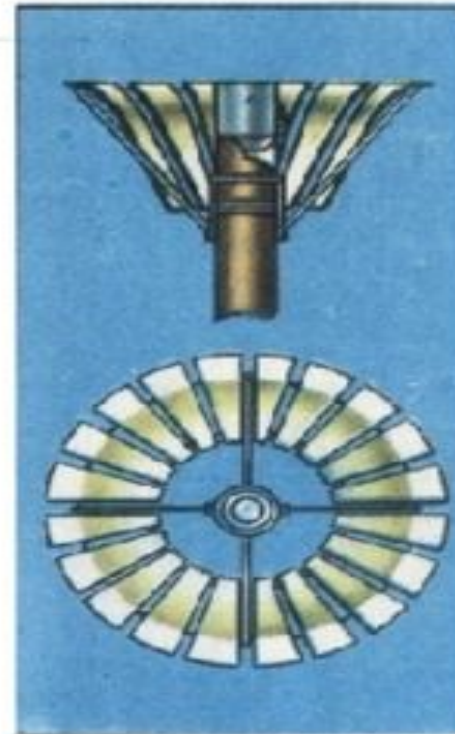
Осадкомер – прибор для измерения количества атмосферных осадков
