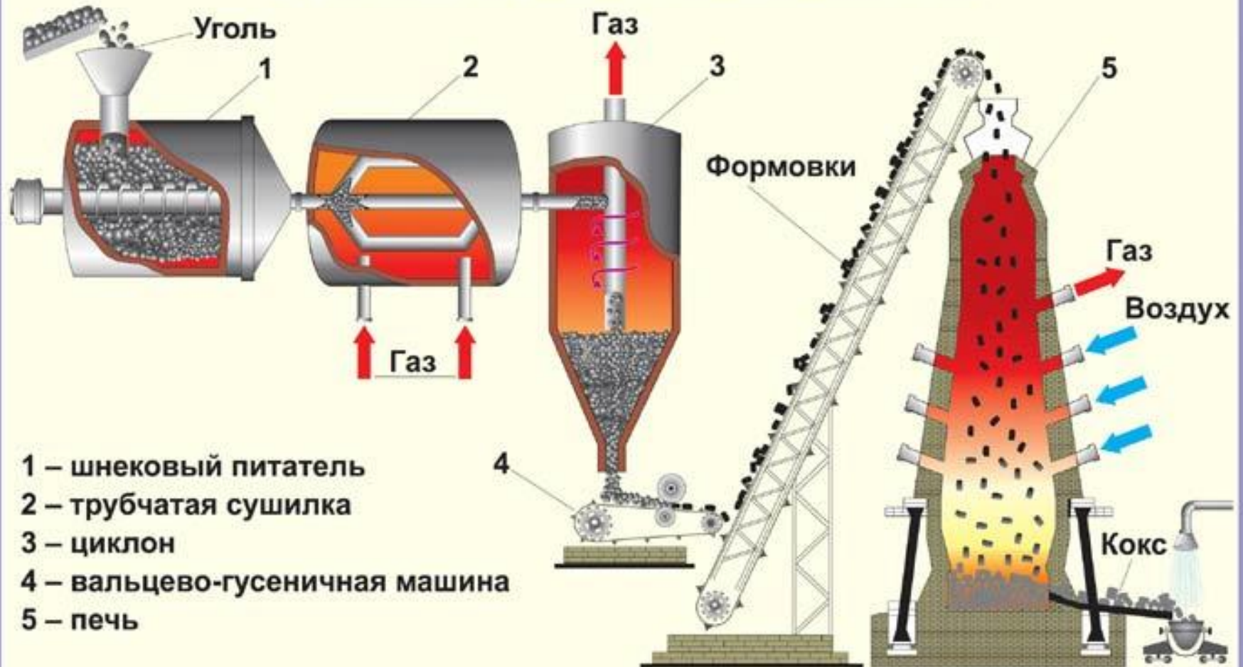
СХЕМА НЕПРЕРЫВНОГО КОКСОВАНИЯ УГЛЯ
