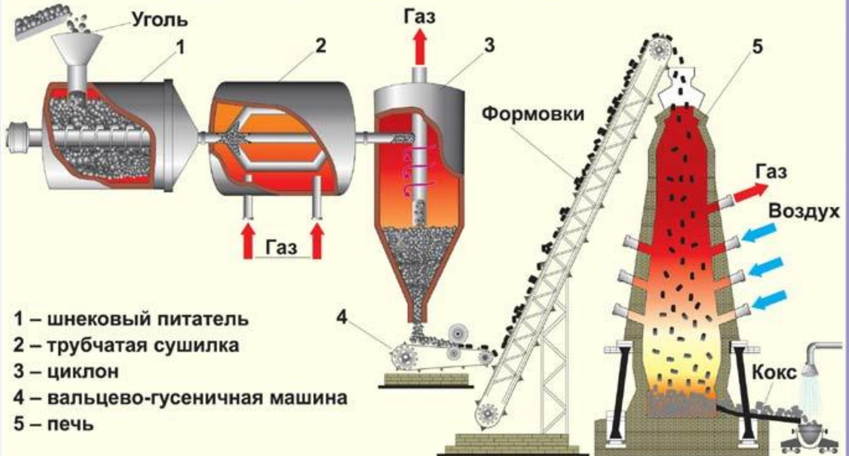
СХЕМА НЕПРЕРЫВНОГО КОКСОВАНИЯ УГЛЯ
