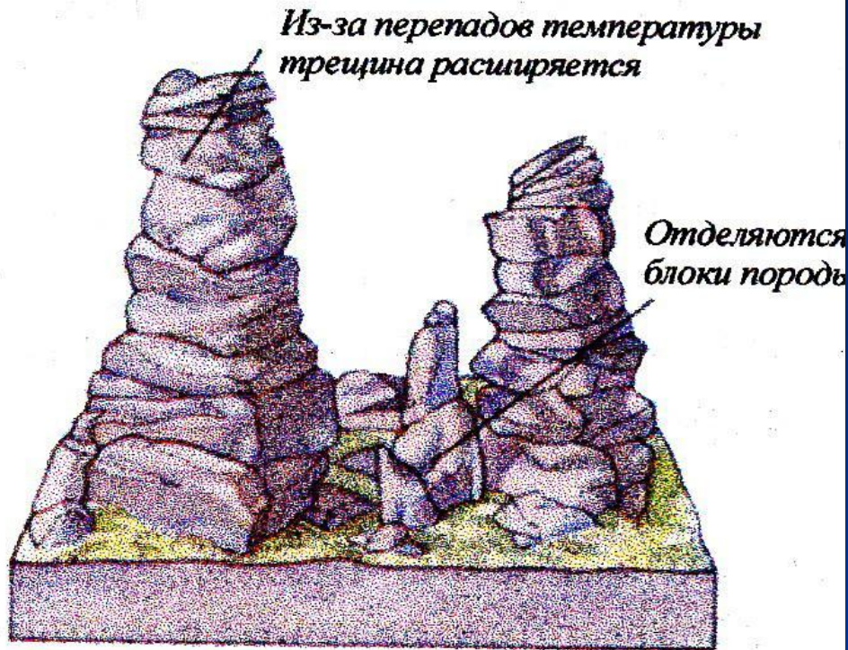
Выветривание по трещиноватости
