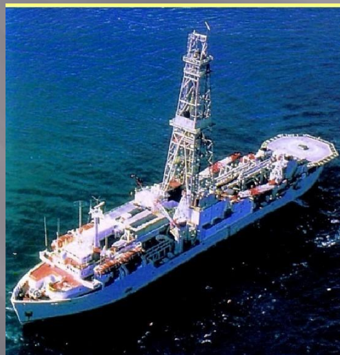
Организация бурения скважин в океане: а – буровой корабль Джоидес Резолюшен, б – организация процесса бурения
