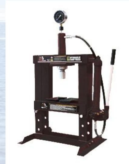
Установка алмазной пилы фирмы Makita и гидравлический пресс Torin для подготовки образцов мерзлого грунта
