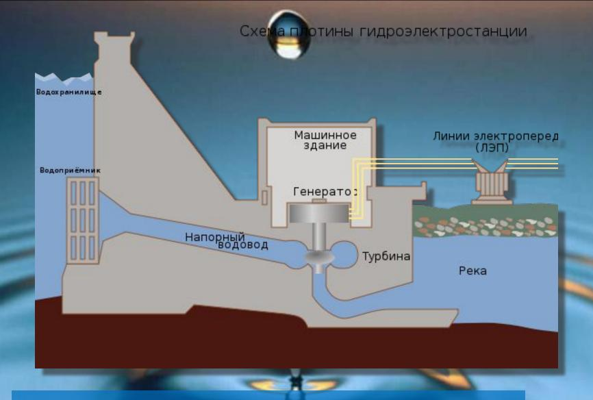
Схема плотины гидроэлектростанции
