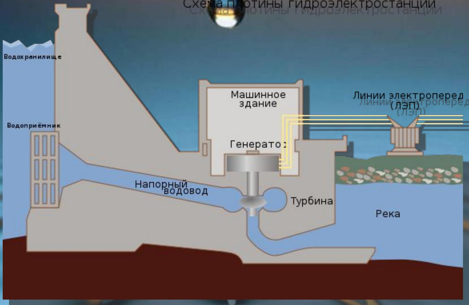
Схема плотины гидроэлектростанции
