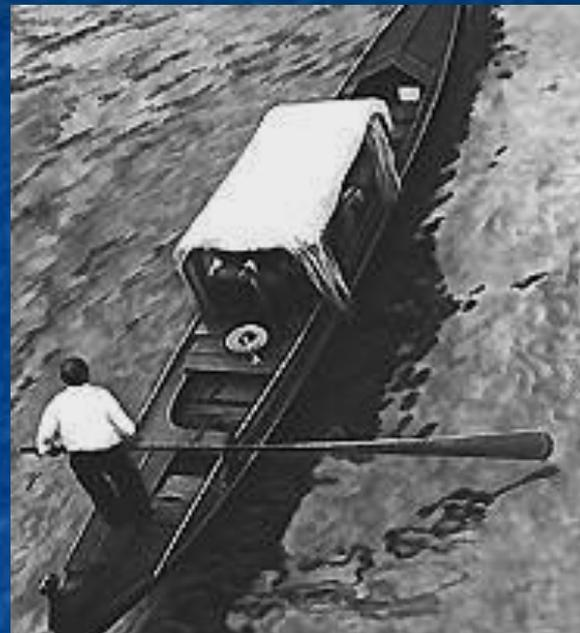
Гондола - одновесельная плоскодонная лодка с приподнятыми фигурными оконечностями.
