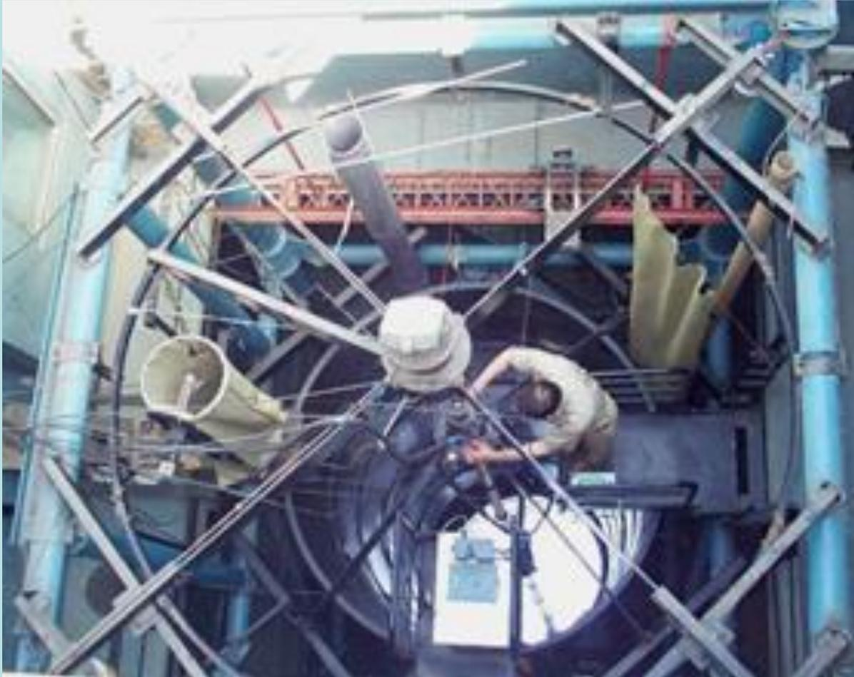
приемные зеркала диаметром 2.2., 1.0., 0.5., 0.3, и 0.27 метра
