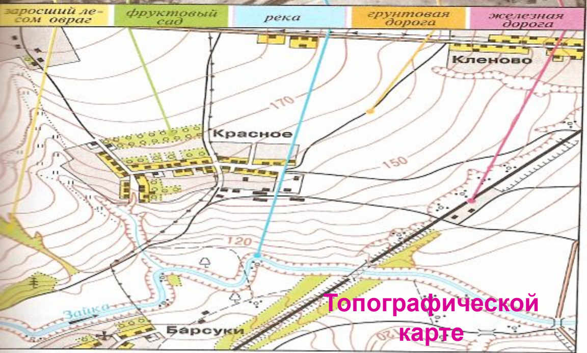
рис. 25. Топографическая карта и аэрофотоснимок на одну и ту же территорию. Условные знаки
