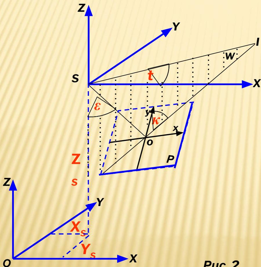
**ЭВО фотоснимка** определяют положение связки проектирующих лучей в момент фотографирования. Другими словами, **ЭВО** определяют положение фотоснимка и его центра проекции в выбранной системе координат.
