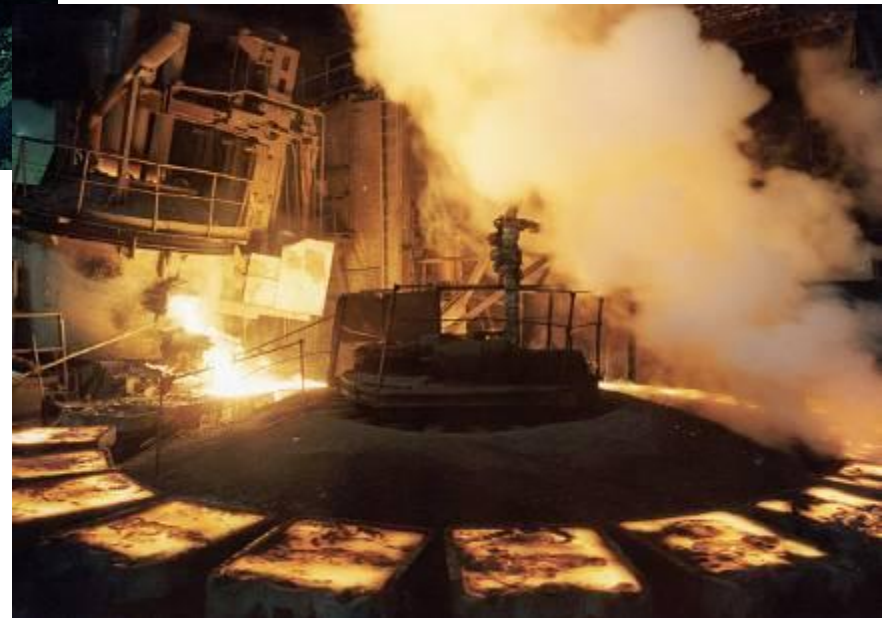
Никелевый завод. Разлив никелевых анодов.
